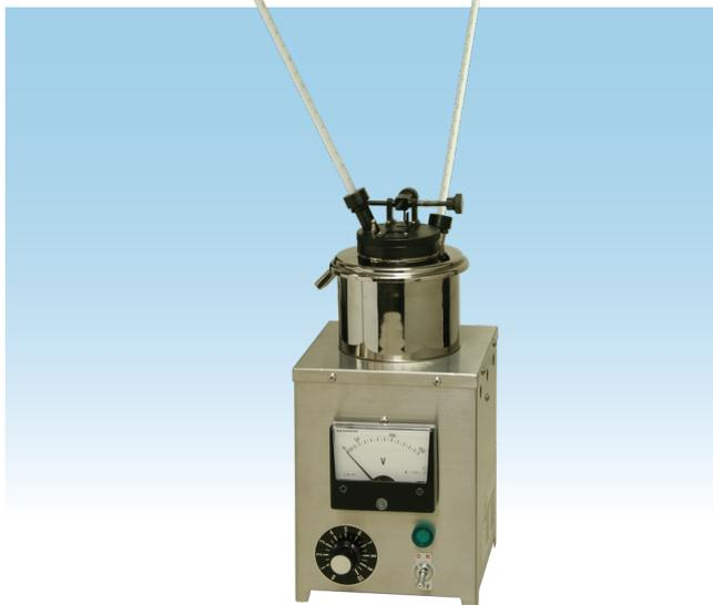
本器は JIS K2265-1、ASTM D56 の規格に準拠した電気加熱式（電圧調節器付）の引火点試験器です。原油、工業用ガソリン、灯油、航空タービン燃料油など引火点が 93℃以下の測定に用いられます。
