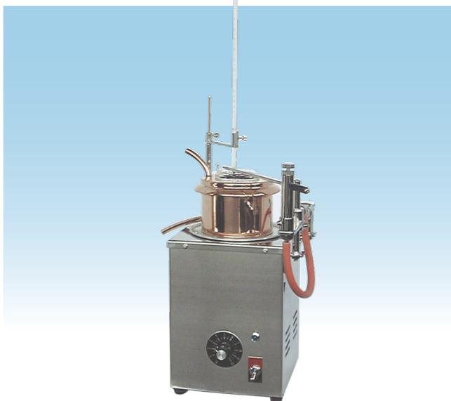
本器は、旧 ASTM D1310 の規格に準拠した電気加熱式（電圧調節器付）の引火点試験器です。引火点が 70℃以下の揮発性液体の引火点並びに燃焼点測定に用いられます。
